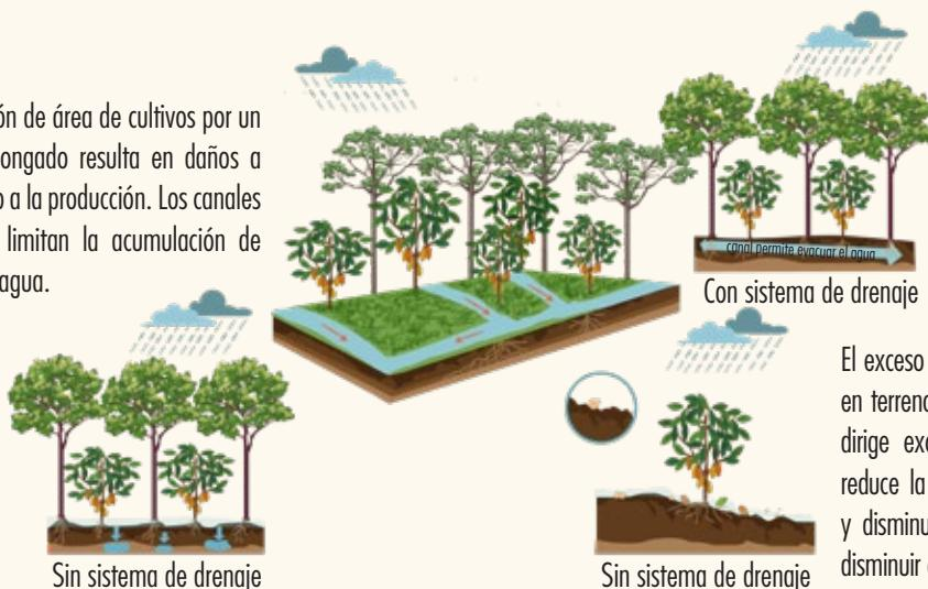
El exceso de agua genera erosión o deslizamientos en terrenos con pendientes. Un sistema de drenaje dirige excesos de agua hacia otras áreas. Esto reduce la intensidad de la erosión en los cultivos y disminuye la infiltración de agua al suelo para disminuir el riesgo de derrumbes.
